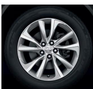
Lijevani naplatci 18" s pet dvostrukih krakova i svjetlom površinskom obradom
